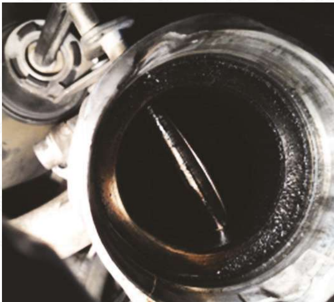
Рис. 4: Запорная заслонка, относящаяся к системе рециркуляции выхлопных газов, закосована
