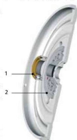
Стандартный DMF – малогабаритный подшипник
