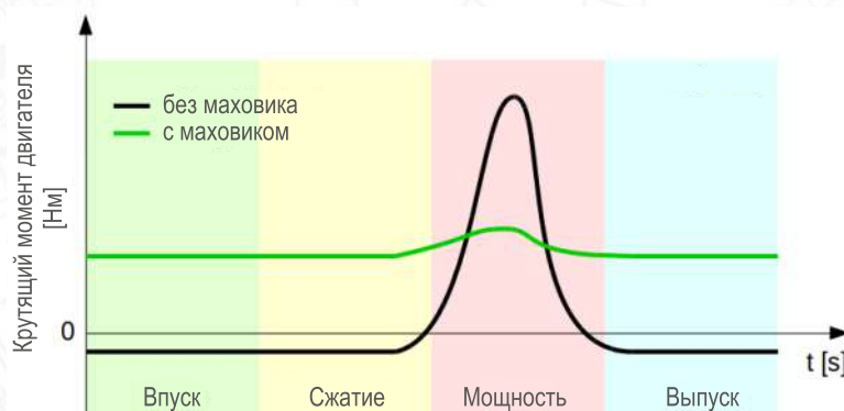
Крутящий момент двигателя во время 4-тактного цикла.
