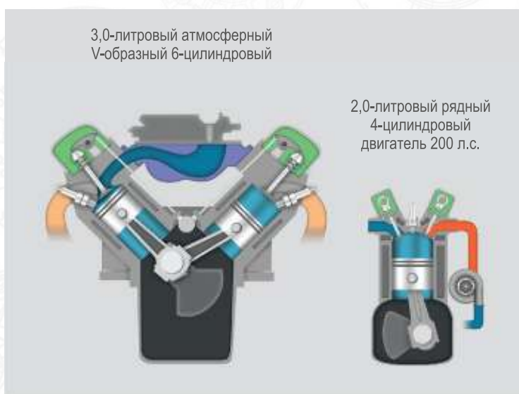
Уменьшение объема двигателя, компенсируемое наддувом с V-образного 6-цилиндрового двигателя до рядного 4-цилиндрового двигателя.
