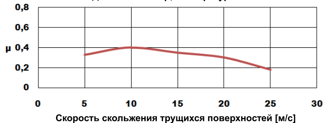
Коэффициент трения по сравнению со скоростью скольжения трущихся поверхностей Давление 10 бар; температура 100°C
