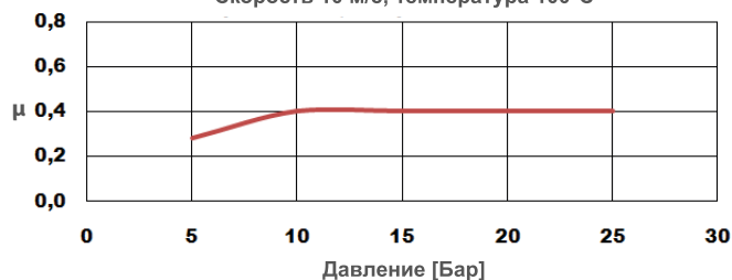
Коэффициент трения по сравнению с давлением Скорость 10 м/с; температура 100°C
