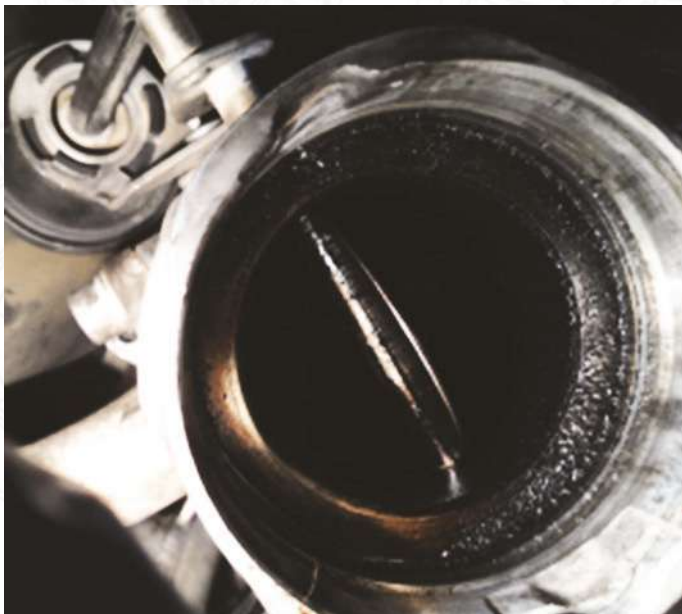
Рис. 4: Запорная заслонка, относящаяся к системе рециркуляции выхлопных газов, закоксована
