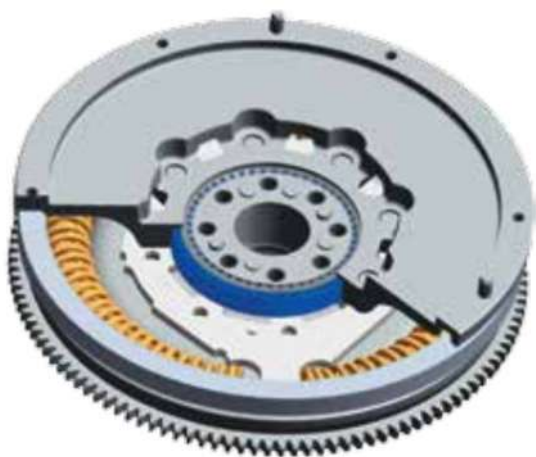
Стандартный DMF – шариковый подшипник
