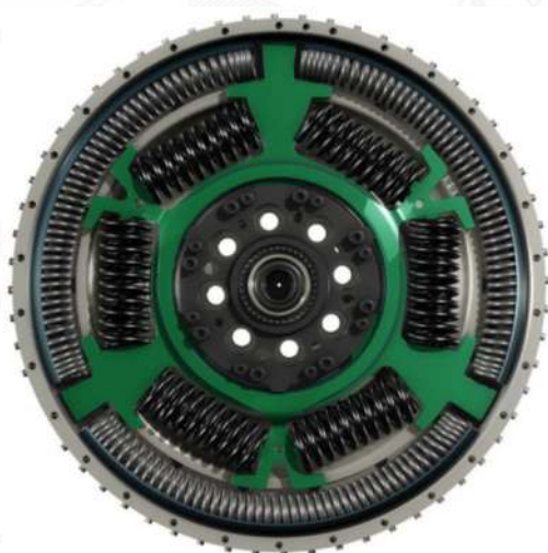
LTD DMF – без нагрузки
