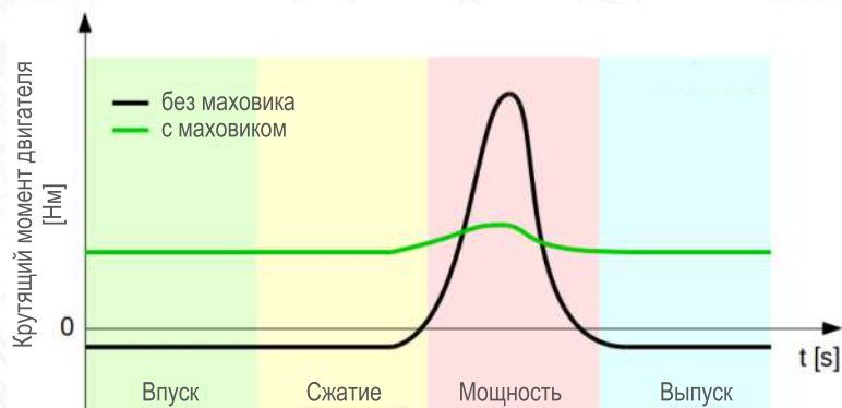
Крутящий момент двигателя во время 4-тактного цикла.
